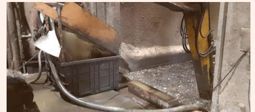
ビットに受けた廃液類の上澄みを吸引してタンクに送水しています。 実はこんな仕事もやっています笑
