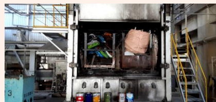
これは、鉄付着物や空のドラム缶を焼却する設備です。この後、鉄くずと灰になって出てきました～
