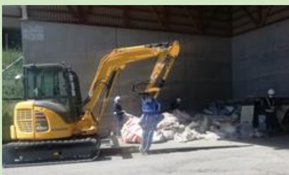
フレコンバックに入った廃棄物の展開検査と選別を行っている様子
